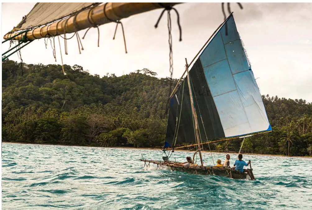
Navigation à la polynésienne sur un Proa (voilier multicoque à balancier) au large des îles Deboyne, en Papouasie-Nouvelle-Guinée. Typique de la Polynésie, le Prau est un voilier de haute mer à ailes delta et balancier toujours au vent / © Photo : Georg Berg
