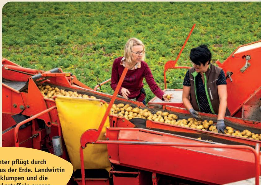
**Am laufenden Band. Der Vollernter pflügt durch die Reihen und zieht die Knollen aus der Erde. Landwirtin Andrea Strixner zeigt, wie Steine, Erdklumpen und die dunkleren und ausgezehnten Mutterkartoffeln aussortiert werden.**
